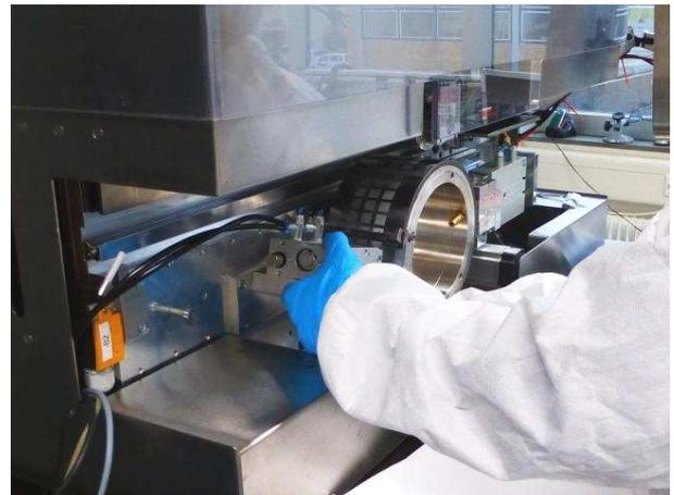
Abbildung 6: Die Tiefdruckmaschine hat das notwendige Fingerspitzengefühl, um feinste Strukturen von Polymerhalbleitern präzise aufzudrucken.
