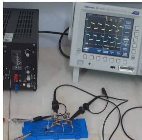
Abbildung 14: Der Multivibrator am Oszilloskop: die Drain-Spannungen der beiden Transistoren.
